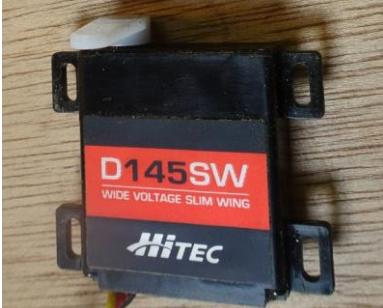
Servo d'ailes programmable en boîtier plastique.
